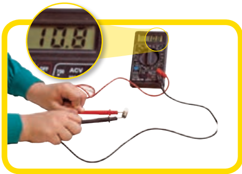
شکل ۸- اندازه‌گیری مقاومت لامپ خاموش با اهم سنج
