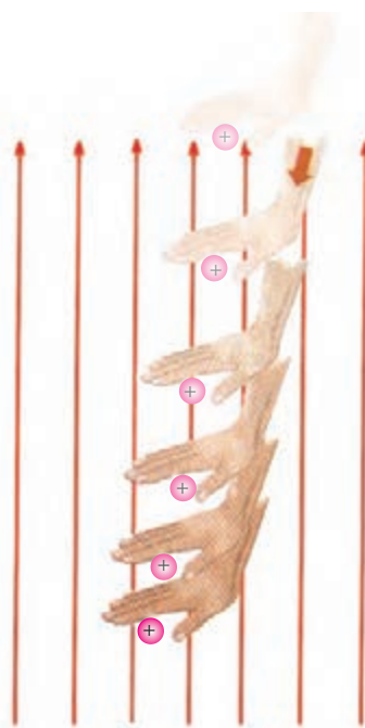
شکل ۲۷-۱ نیروی خارجی، بار +q را در خلاف جهت میدان الکتریکی جابه‌جا می‌کند.
