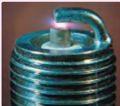
انرژی لازم برای جرقه زدن شمع خودرو، از انرژی ذخیره شده در میدان مغناطیسی پیچۀ احتراق تأمین می شود.
