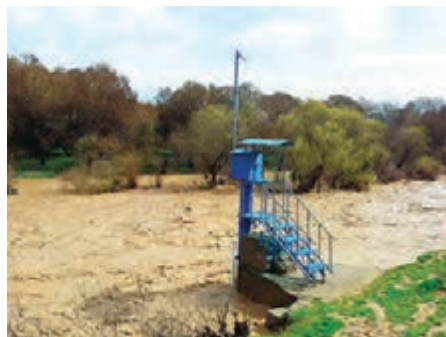
شکل ۲-۳. ایستگاه اندازه‌گیری آبدهی رود
